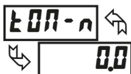
Entrer le temps (en secondes) dont l'alarme est retardée à l'ouverture après que le point de déclenchement ai été atteint. Une valeur de 0.0 permet à l'afficheur de mettre à jour l'état de l'alarme en fonction du temps de réponse décrits dans les spécifications. Si la logique de sortie est  $rEu$ , ceci devient le délai à la fermeture. Le temps accumulé lors d'une coupure d'alimentation est remis à zéro au redémarrage.
