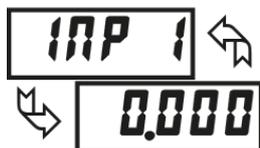
En mode **KEY**, entrer la valeur d'un signal connu en utilisant les touches fléchées. La plage d'entrée définit la position du point décimale. En mode **RPLY**, appliquer le signal à l'entrée de l'appareil, régler la source de signal externe jusqu'à ce que la valeur d'entrée souhaitée apparaisse. Pour les 2 méthodes, presser **PAR** pour sauver la valeur affichée.
