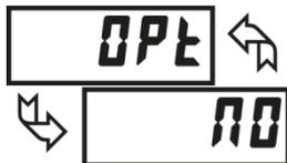
**YES** - Entrer dans le sous-menu pour sélectionner les paramètres devant apparaître dans le bloc de données. Pour chaque paramètre du sous-menu, sélectionner **YES** pour que le paramètre apparaisse dans le bloc de données, et **NO** pour désactiver le paramètre.
