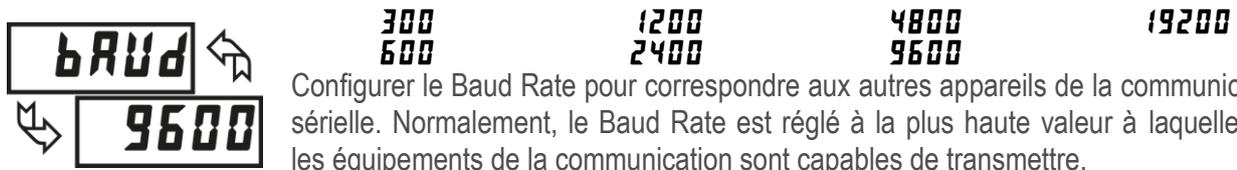
Configurer le Baud Rate pour correspondre aux autres appareils de la communication sérielle. Normalement, le Baud Rate est réglé à la plus haute valeur à laquelle tous les équipements de la communication sont capables de transmettre.
