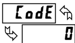
En entrant une valeur différente de zéro, l'invite **Code 0** apparaîtra lorsqu'on essaye d'ici accéder. L'accès sera autorisé uniquement après y avoir entré le code correspondant, ou le code d'accès universel **222**. Avec ce code, une entrée utilisateur n'a pas à être configurée pour le blocage de la programmation. Cependant, ce blocage est outrepassé par une entrée utilisateur inactive configurée en blocage de programmation.
