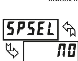
Sélectionner le seuil (sortie relais) devant être programmé. Le **n** dans les paramètres suivants correspondra au numéro du seuil choisi. Après que le seuil choisi ait été entièrement programmé, l'affichage retournera à **SPSEL NO**. Répéter les étapes pour chaque seuil à programmer. Sélectionner **NO** à **SPSEL** retournera à **PRO NO**. Le nombre de seuils disponibles est fonction de la carte de sortie.
