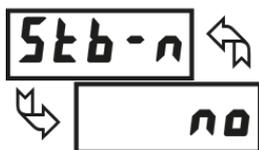
Pour **YES**, l'alarme est désactivée (après un redémarrage) jusqu'à ce que le point de déclenchement soit franchi. Une fois l'alarme à "on", l'alarme fonctionne normalement suivant les figures de déclenchement et l'action de réinitialisation.
