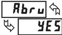
Sélectionner transmission abrégée (uniquement des nombres) ou transmission complète. Lorsque l'afficheur envoie les données directement à un terminal pour affichage, les autres caractères envoyés identifient la nature du paramètre. Dans ce cas, sélectionner **NO**. Quand les données sont envoyées à un ordinateur, il peut être utile de supprimer l'adresse de l'afficheur et le code mnémotechnique lors de la transmission. Dans ce cas, sélectionner **YES**.
