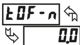
Entrer le temps (en secondes) dont l'alarme est retardée à la fermeture après que le point de déclenchement ai été atteint. Une valeur de 0.0 permet à l'afficheur de mettre à jour l'état de l'alarme en fonction du temps de réponse décrits dans les spécifications. Si la logique de sortie est  $rEu$ , ceci devient le délai au déclenchement. Le temps accumulé lors d'une coupure d'alimentation est remis à zéro au redémarrage.
