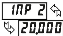
En mode **KEY**, entrer la valeur d'un second signal connu en utilisant les touches fléchées. En mode **RPLY**, appliquer le signal à l'entrée de l'appareil, régler la source de signal externe jusqu'à ce que la valeur d'entrée souhaitée apparaisse. (Suivre la même procédure pour plus de 2 points de linéarisation.)
