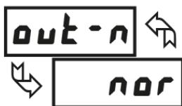
Entrer la logique de fonctionnement de la sortie d'alarme. Le **nor** laisse la sortie fonctionner normalement. La logique **rEu** inverse la logique de sortie. En **rEu**, les états d'alarmes des figures de déclenchement sont inversés.
